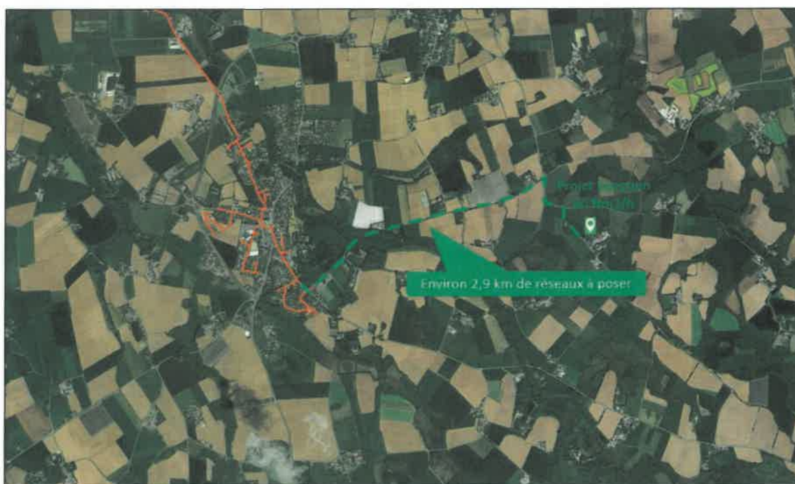
Figure 8 : Tracé du raccordement pour rejoindre le réseau de Ploudaniel
